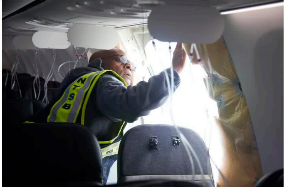
Ansvarig utredare John Lovell undersöker flygkroppens pluggområde på Alaska Airlines Flight 1282 Boeing 737-9 MAX. (Bild: NTSB)
