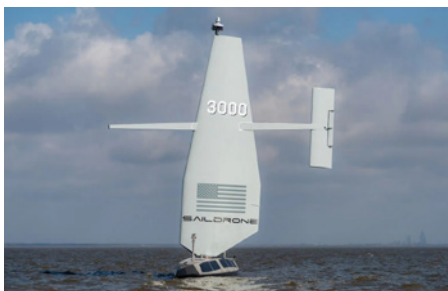
Saildrones första autonoma Surveyor-fartyg med aluminiumskrov träffar vatten för prov
