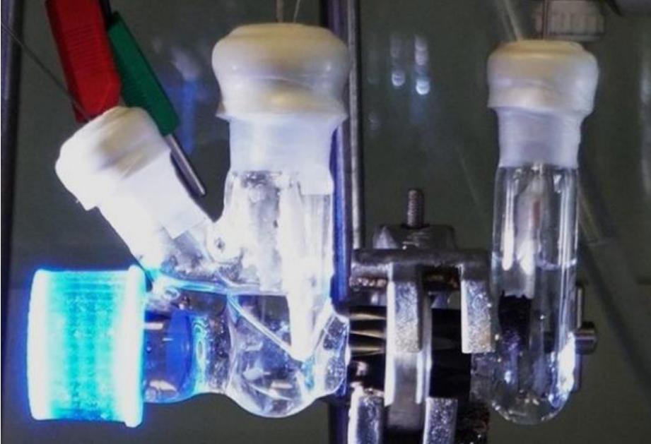
Kolavskiljning från luft och dess fotoelektrokemiska omvandling till bränsle med samtidig omvandling av plastavfall till kemikalier. (Bild: Ariffin Mohamad Annuar)
